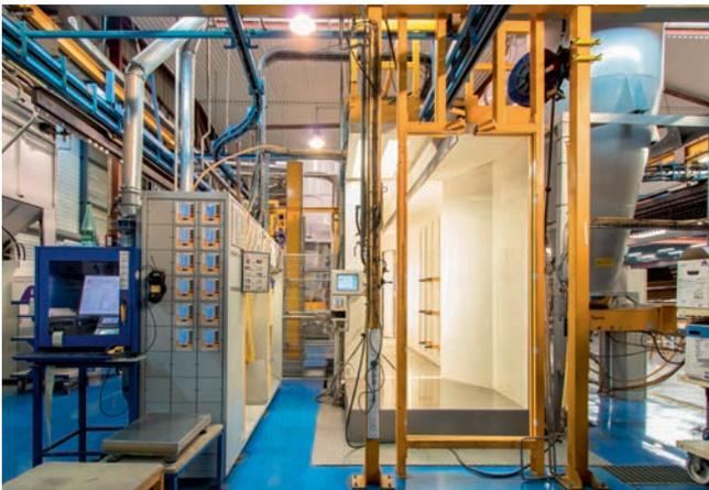
Mit dem neuen System lassen sich mit einer Kabine und einer Applikations-einrichtung Farbwechsel innerhalb von 60 Sekunden durchführen.
