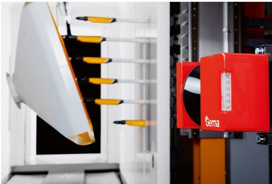
Der Scanner detektiert die Konturdaten und übermittelt sie via Steuerung an die Pistolen auf einem Hubgerät, die sich in Abhängigkeit zur Fördergeschwindigkeit individuell und exakt in der Tiefe positionieren.
