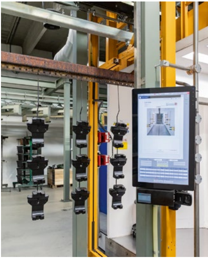
Pistolenanordnung und Beschichtungsparameter werden auf großen Bildschirmen visualisiert.
