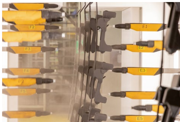
20 Automatikpistolen folgen in der Kabine exakt den Konturen der Teile.
