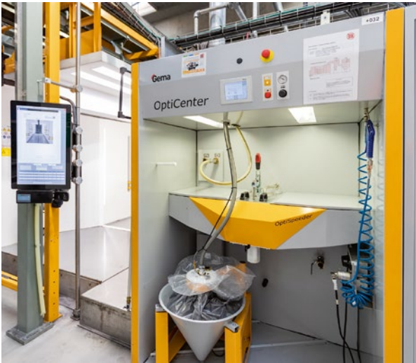
Das Pulverzentrum mit Applikationspumpen versorgt die Automatikpistolen mit Pulver.
