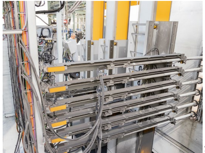
Jede Automatikpistole ist auf einer Zustellachse platziert und wird individuell positioniert.
