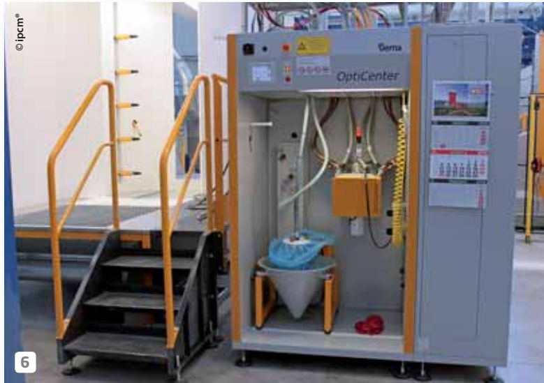
6 The integrated OptiCenter powder management system. Il sistema integrato per la gestione della polvere OptiCenter.
