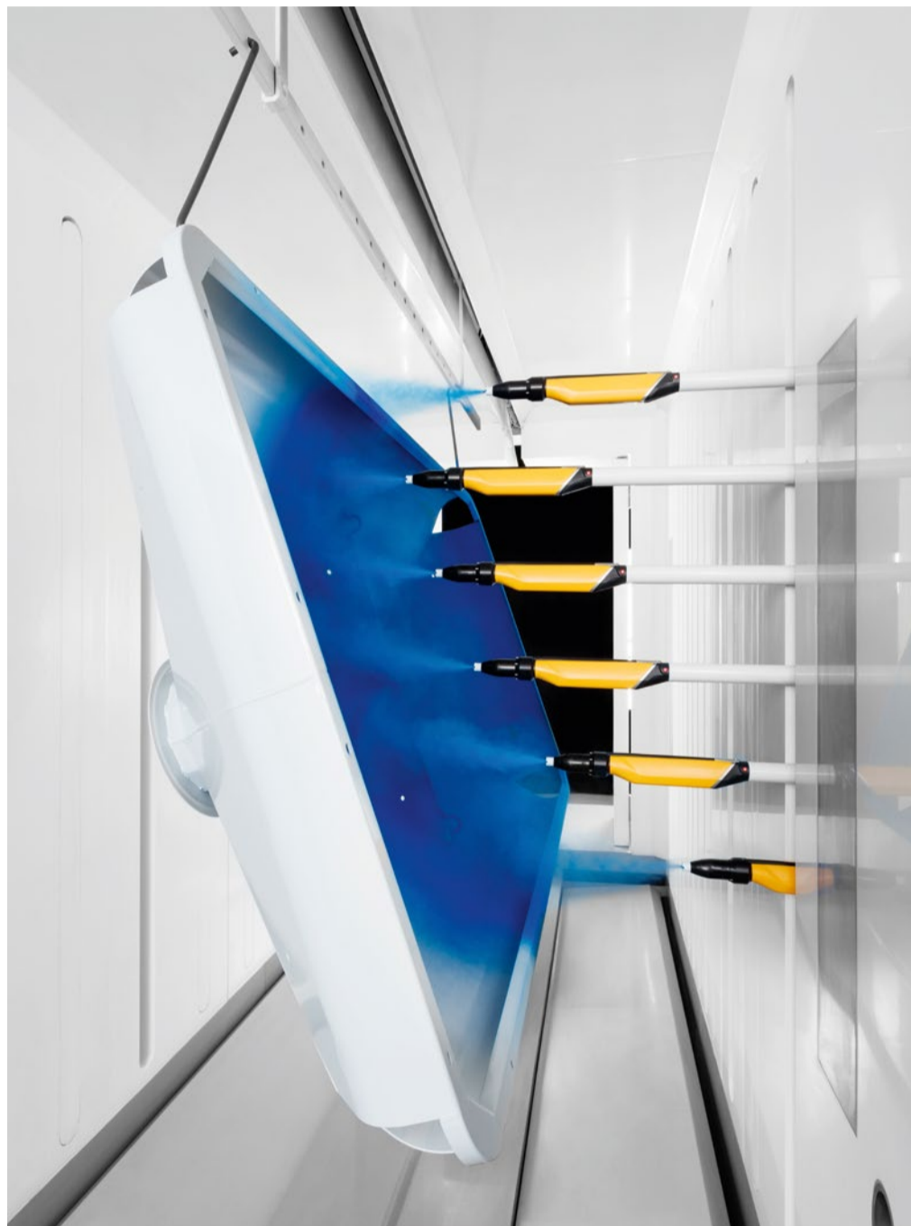
Das System erfasst punktgenau die Produktgeometrie und die Beschichtungspistolen werden laufend im optimalen Beschichtungsabstand positioniert.
