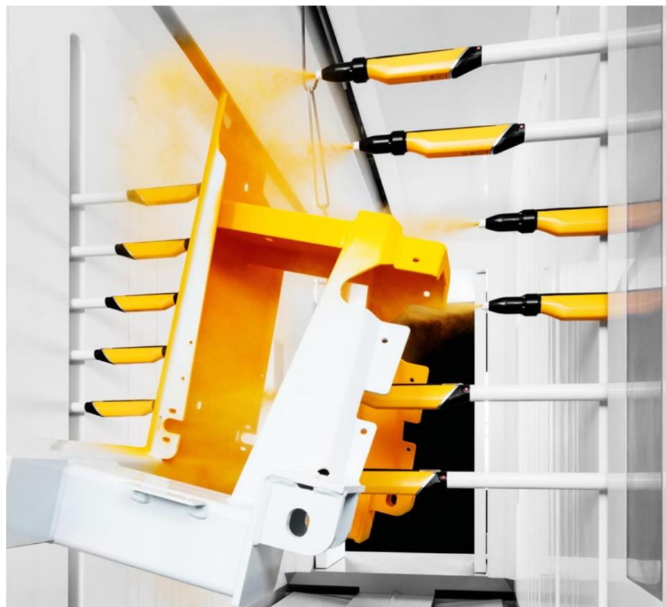
Mit der weiterentwickelten Technologie wird die Anwendung auf die komplexesten Komponenten und Geometrien ausgeweitet und ist von kleinen bis zu XXL-Teilen vollständig skalierbar. Foto/Grafik: Gema
