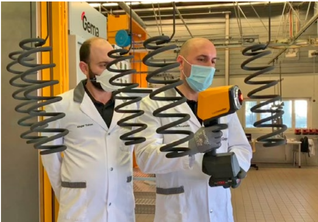
Regelmäßige Schichtdickenmessungen helfen sowohl bei der Prozessoptimierung als auch bei der Ergebnisbewertung durch den Kunden.
