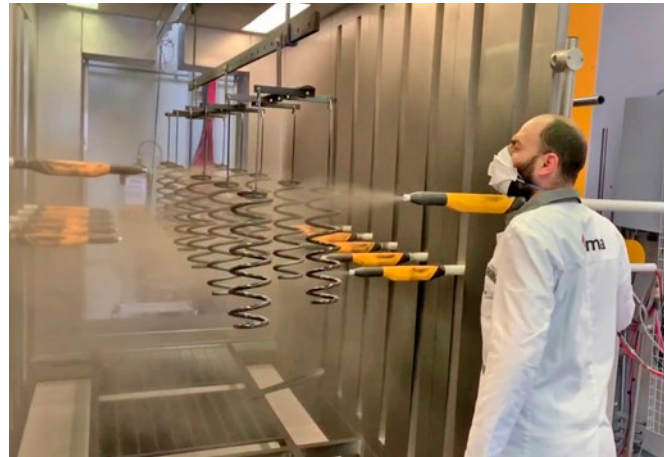
Nach dem Kick-off-Meeting erfolgen Versuchsaufbau und erste Beschichtungsversuche im Kundenlabor durch das Gema-Team.
