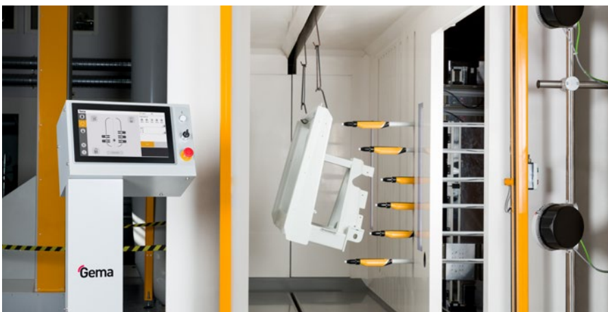
Die neueste Generation der Dynamischen Konturerkennung arbeitet erheblich schneller, dadurch können komplex geformte Bauteile ohne Programmieren optimal beschichtet werden.
