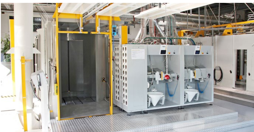
In der MagicCylinder-Kabine kann mit dem neuen IG07 Injektor (links) oder dem neuen OptiStar All-in-One (rechts) gearbeitet werden. Die integrierten Steuergeräte sparen deutlich Aufstellfläche ein.
