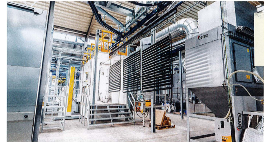
Die Automatikkabine arbeitet mit Injektortechnik, die benötigten Prozessparameter werden anlagenweit automatisch von den Traversen übergeben und dann aktiviert.
